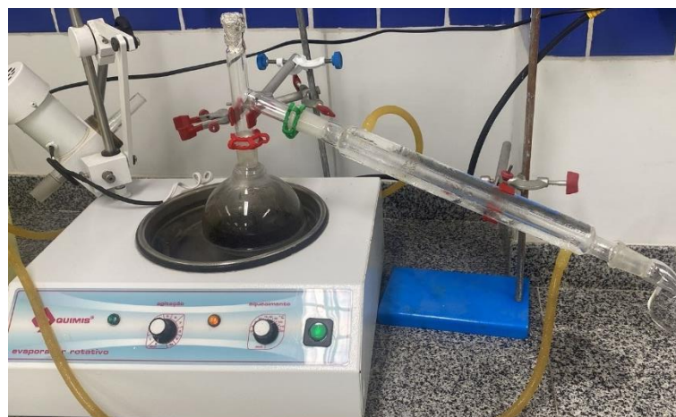
Figura 15 – A solução da maceração na máquina evaporadora rotativa para evaporação do líquido extrator metanol.
