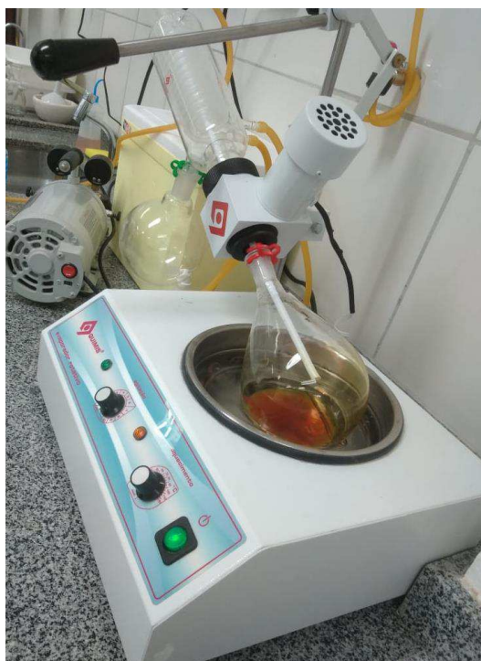
Figura 3: Utilização do evaporador rotativo para remoção do solvente extrator
