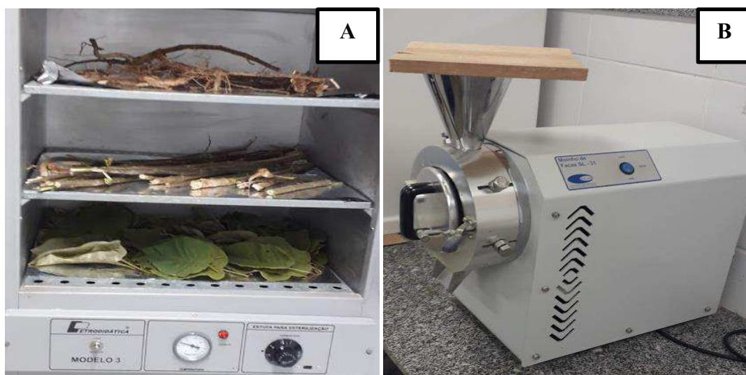
FIGURA 6: Processo de secagem e trituração do marmeleiro ( Croton blanchetianus ) (A: Partes do marmeleiro na estufa; B: Moinho de facas usado para triturar as partes da planta.)
