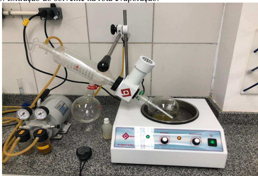
FIGURA 8: Extração do solvente na rota evaporação.
